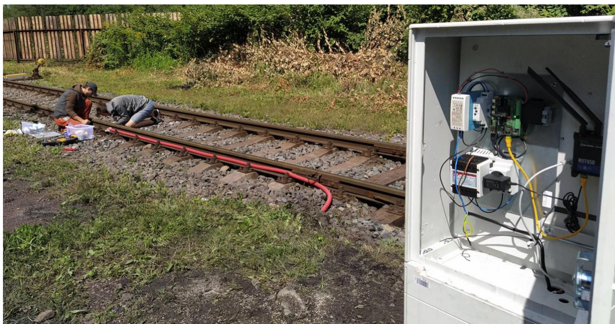
Obr. 3: Testování dílčích částí IoT senzorského zařízení na železniční trati v ČR
